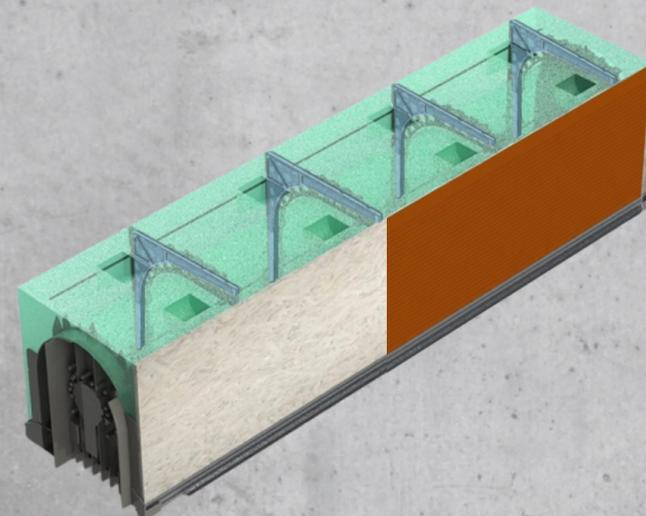
Les versions XL sont renforcées avec des équerres aluminium moulées à la fabrication. Ils sont certifiés pour une largeur jusqu'à **5100 mm**.
